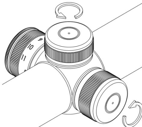
Abb. 6: Entfernen der Kappen von Höhen- und Seitenturm
