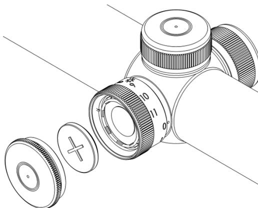
Abb. 5: Batteriewechsel
